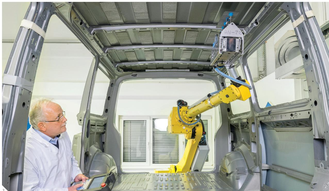
1 スチールのキャビティ内で膨張したSikaBaffle® 2 SikaDamp®の自動施工
