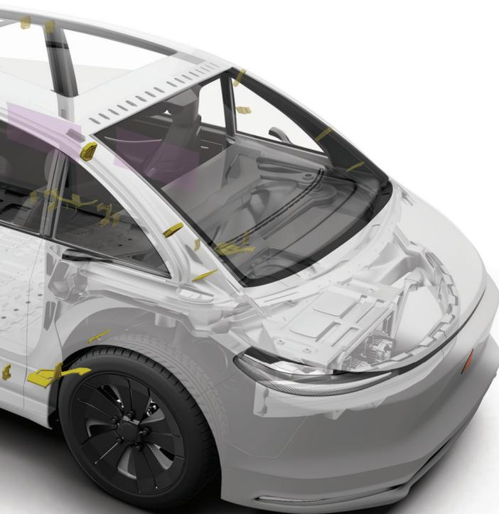
SikaDamp®ソリューションは、エラストマーやアスファルトを素材とする幅広い制振材の製品群で構成されており、拘束層と併用することもできます。業界をリードする制振性能を備えながら、クラス最高の重量性能比を達成したSikaDamp®は、車両組立工程のどの段階でも使用でき、プレス位置に取り付けることもできます。
