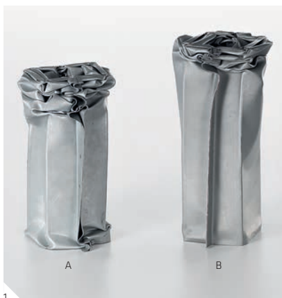
1 衝撃試験の結果：(A) 溶接のみ (B) 溶接に加えてSikaPower®耐衝撃構造用接着剤を使用
