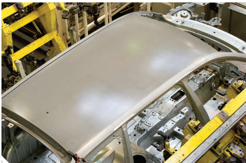
1 ルーフクロスメンバーへの アンチフラッターの塗布 2 車体フレームへの完成済み ルーフの接着
