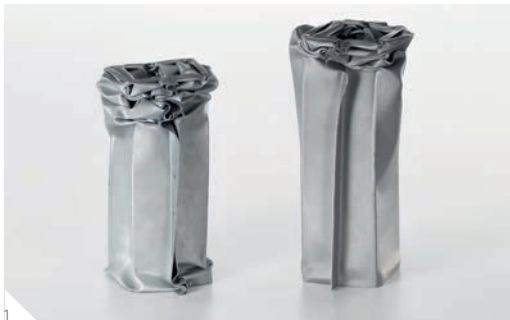
1 衝突後のビームの比較 SikaPower®不使用(左)と使用(右)
