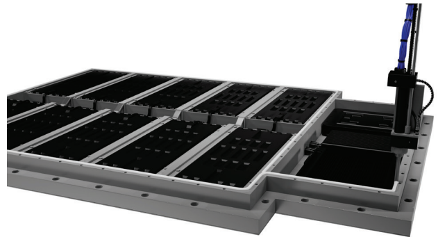
シーリングの塗布
