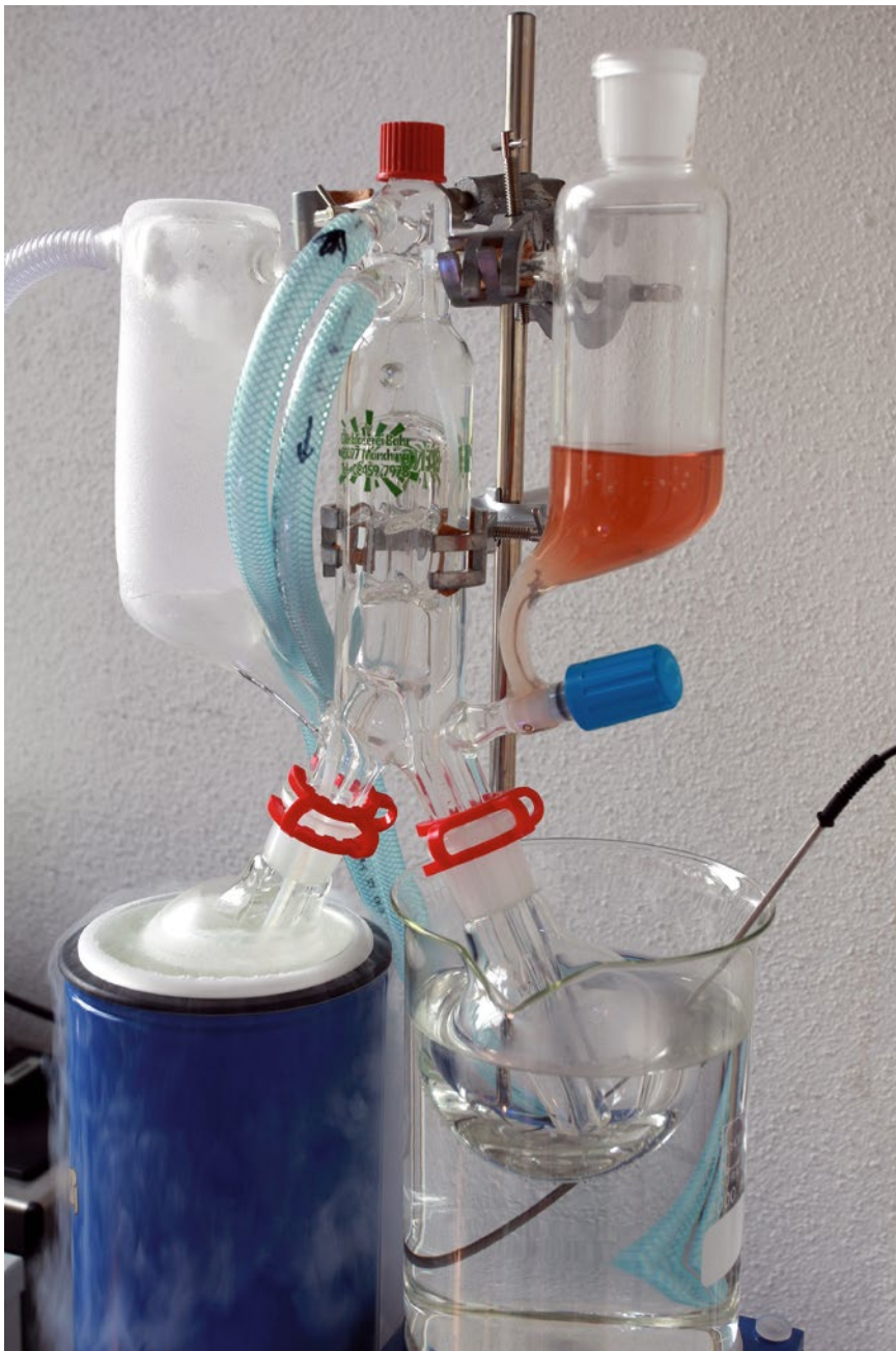
Bild 1 > Die Trennung der flüchtigen Verbindungen von nicht-flüchtigen Bestandteilen erfolgt mittels Solvent Assisted Flavour Evaporation (SAFE)-Technik /1/.
